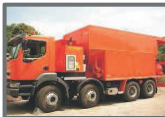
Mezzo d'opera per al realizzazione di massetto premiscelato
