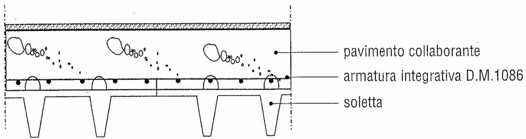
Fig.2.4 Pavimento su pavimento preesistente
