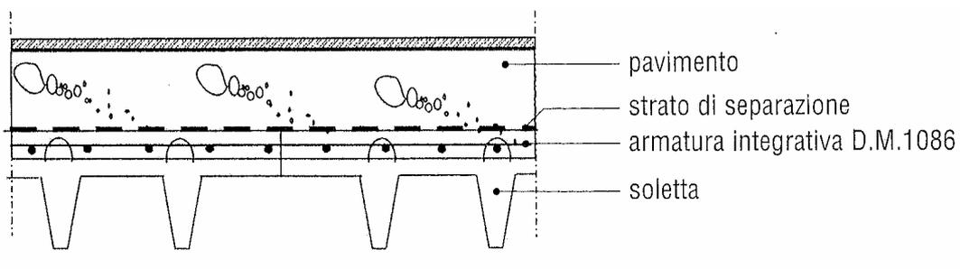
Fig.2.3 Pavimento collaborante con soletta
