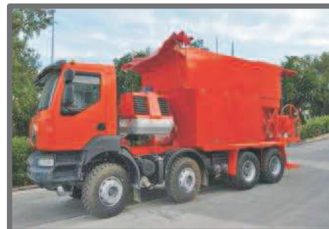
Mezzo d'opera per la realizzazione ed il pompaggio dell'argilla espansa.
